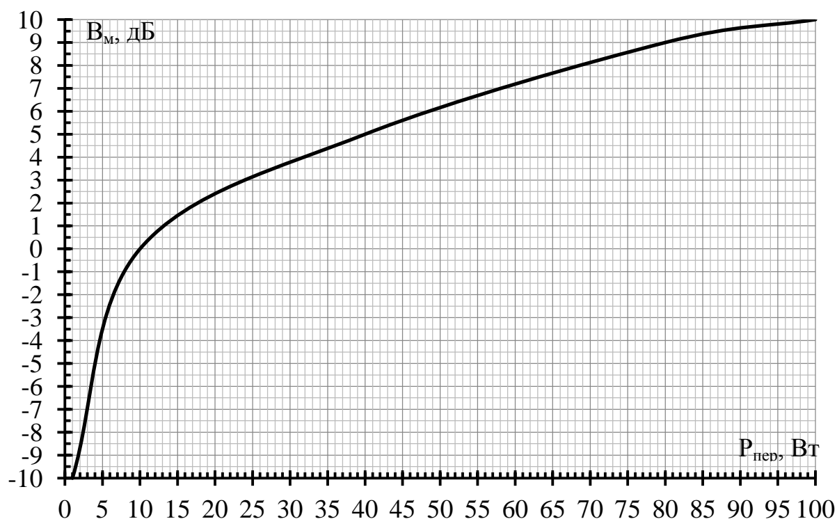
Рис. 3.1. Зависимость мощности радиостанции от поправочного коэффициента B_m
